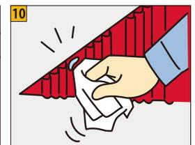
製品の表面に接着剤が付着しているとその部分が反射しません。接着剤が付着した場合は必ず拭き取ってください。
