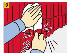
製品のフラット部分を強くこすり圧着させます。波部分は山をつぶさないように軽めに押さえてください。
