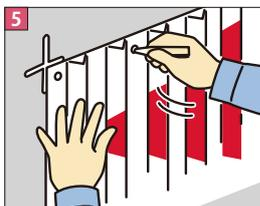
5 墨入れた箇所(墨入り)に製品を押しあて、製品の丸孔(ボード無タイプはV型もしくはL型製品本体に、ボード有タイプはボード)に合わせてアンカーの穿孔位置をマーキングします。製品の丸孔は製品により多少の誤差があるので、必ず設置する製品を使いマーキングしてください。
