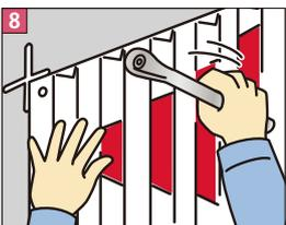
8 製品を接置面に押さえつけ、アンカーを挿入し製品を固定します。
