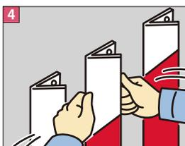
4 製品裏面に貼付けてある両面テープの離型紙を剥がし、設置面へ圧着し仮止めする。
