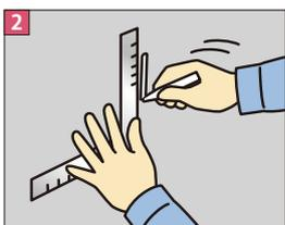
2 遮音壁に製品の設置間隔をマーキングしていきます。まず設置位置の始点をマーキングします。
