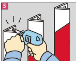
5 支持体孔に合わせて、リベット下孔をドリルなどで穿孔します。(φ5mm)
