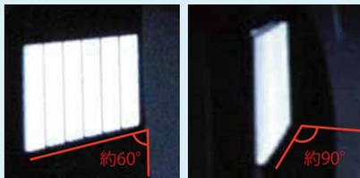
当たった光をそのまま光源に反射するので、まるでウェーブリフレクター自体が光源体のように明るく浮かび上がります
