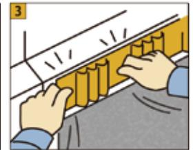
製品全体を軽く押さえ、仮止めし、製品のフラット部分を強くこすり圧着させます。波部分は山をつぶさないように軽めに押さえてください。
