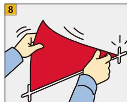
設置位置を再度確認して設置面のマーキングに合わせ貼付けます。貼直し(2度貼り)は粘着力が低下しますので必ず一度で貼付けるようにしてください。
