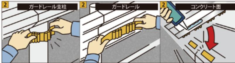
ミニウェーブ・リフレクター裏面の離型紙を剥がし、引き伸ばさずに接着面(ガードレール支柱・ガードレール)に貼付けてください。
