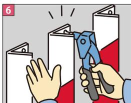
6 製品を設置面に押さえつけ、リベットで製品を固定する。
