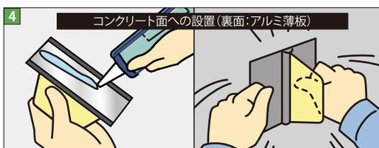
支持体裏面のアルミ薄板部分に接着剤(セメダインPM165)を1mmの厚さで全面を均等に塗ってください。
