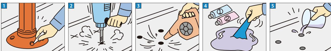
1 路面にウェーブポストを置き、設置する位置にチョークなどでマーキングします。設置位置はなるべく平らな場所をお選びください。
