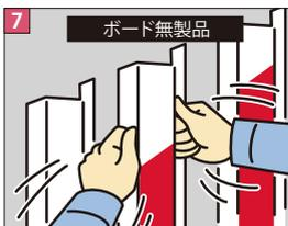
7 ボード無製品 製品裏面の離型紙を剥がし、設置面へ圧着し仮止めします。
