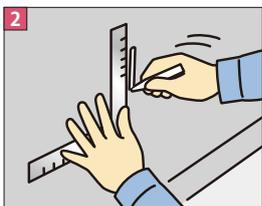
2 コンクリート壁高欄面に製品の設置間隔をマーキングしていきます。まず設置位置の始点を決めます。
