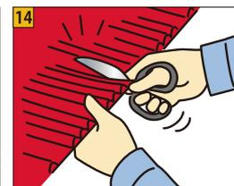
製品カットの際はハサミを使用し、製品のフラット部分の中央をカットするようにしてください。
