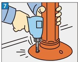
7 ウェーブポスト本体を据付、ボルトをインパクトレンチなどで締め付けてください。(ボルト17角)
