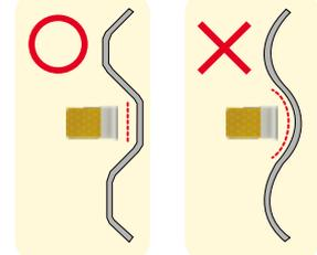
ガードレールへの施工の際、貼り付け部位がフラットでないとうつきません。フラットでない場合は、支柱への貼り付けをお願いいたします。
